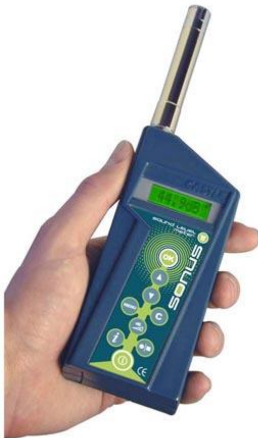
Ηχώμετρο ακριβείας τύπου 2 της CASTLE, μοντέλο GA 216 I, σύμφωνα με τις προδιαγραφές IEC61672-1-2002.
