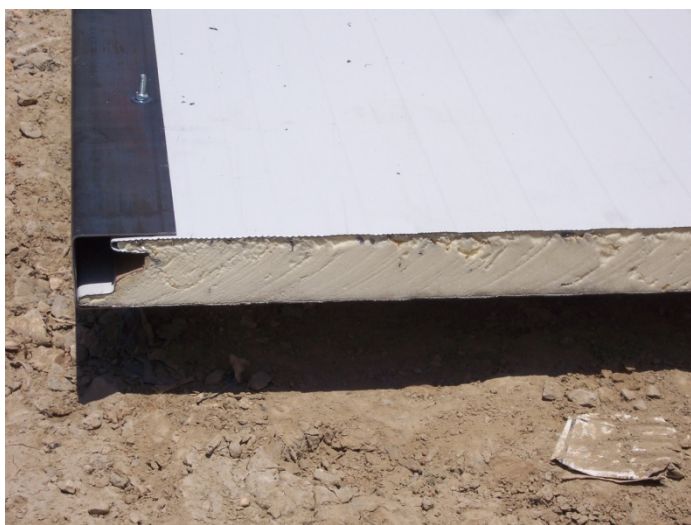
Απορροφητικό υλικό για την κατασκευή των κινητών ηχοπετασμάτων στην περιοχή της γέφυρας του π. Σπερχειού.
