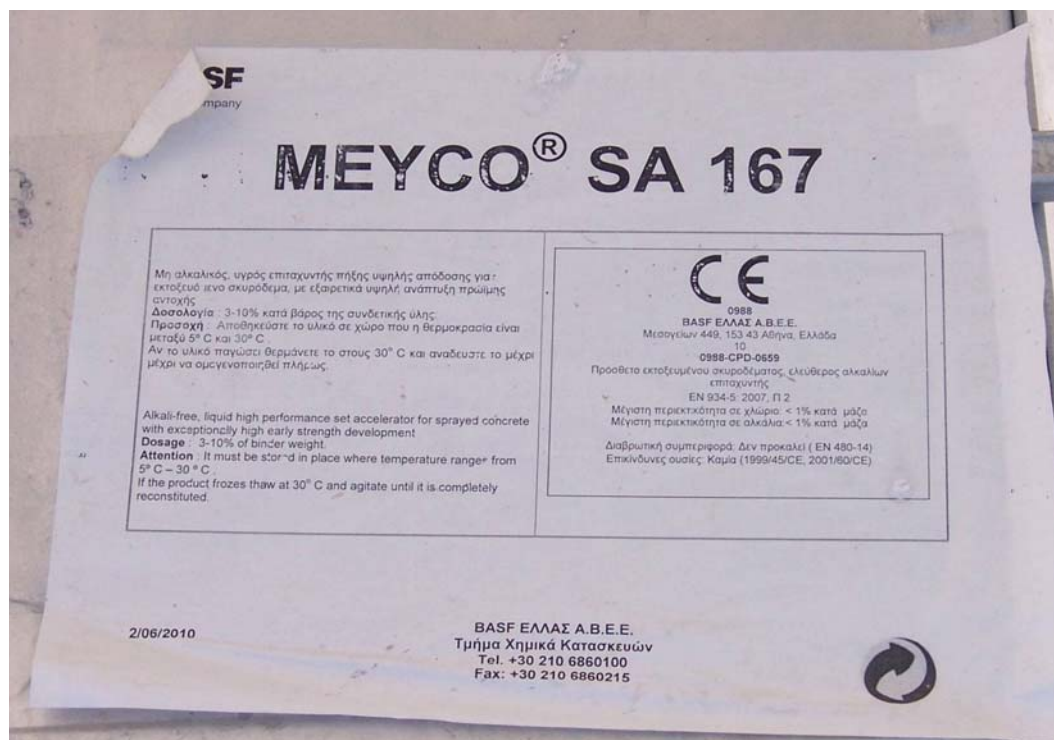
Χρήση μη αλκαλικών επιταχυντών πήξης για εκτοξευόμενο σκυρόδεμα.
